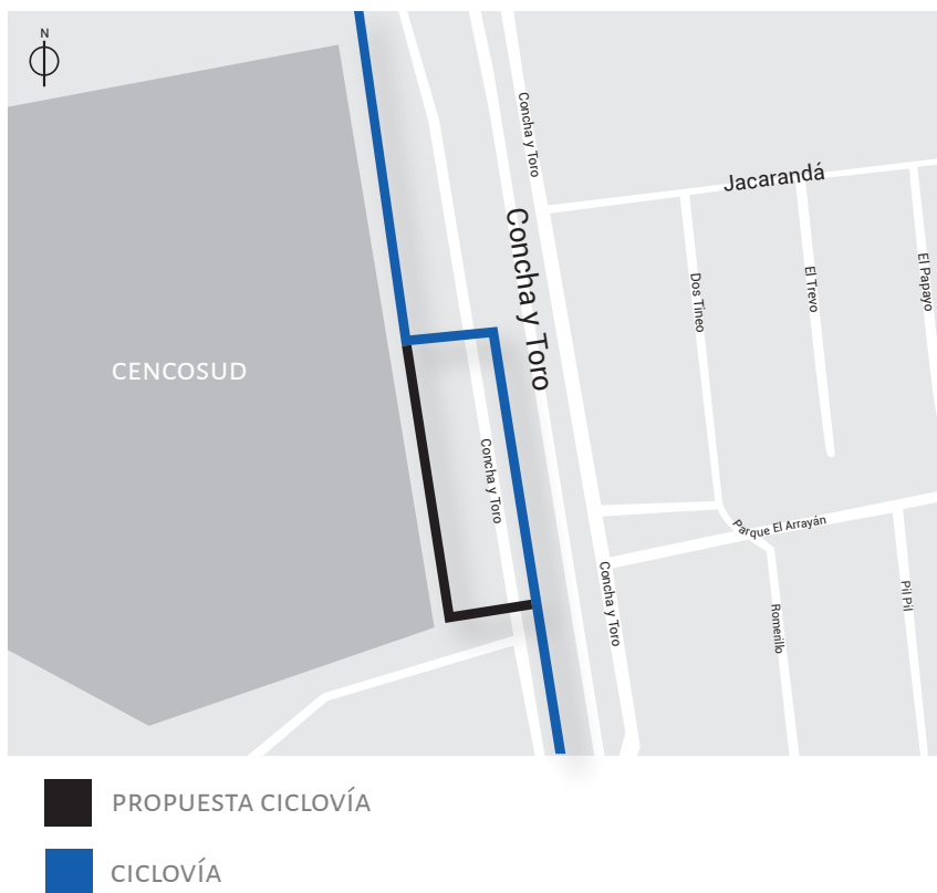
Figura 7. Desplazamiento ciclovía en intersección Jacarandá. Fuente: Elaboración propia.
