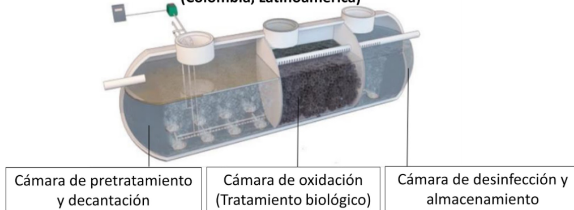
c) Planta compacta para tratamiento de aguas grises (Colombia, Latinoamérica)
